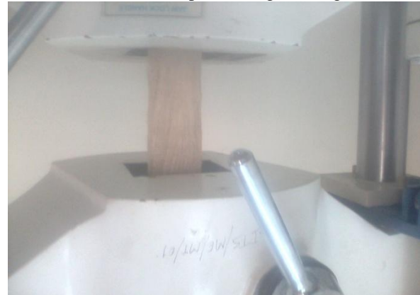
3(f) Tensile test
